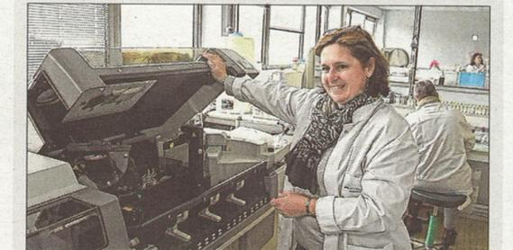
Les imposants automates analysant les prélèvements de sang nécessitent un calibrage d'une heure. Photo ER/Cedric JACQUOT
